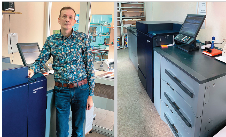
Сергей Волошановский: «IQ-501 открыл нам глаза. Раньше мы просто не знали, какое количество брака произвела наша печатная машина и в пределах каких допусков находятся тиражные листы». Справа — та самая Konica Minolta AccurioPress C6085 с модулем IQ-501
